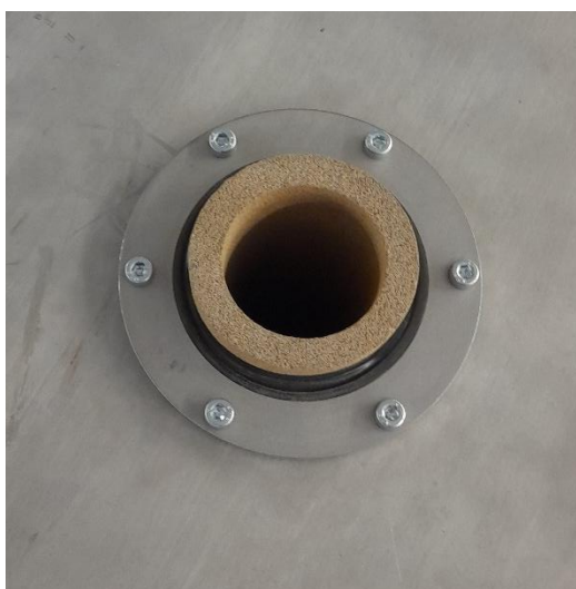
Figura 2. Sujeción de los elementos filtrantes cilíndricos.
