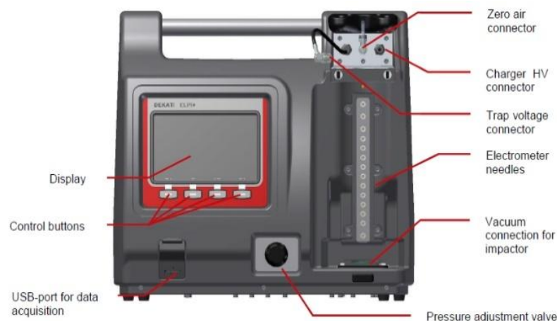
Figura 26. Esquema de la unidad principal del sistema ELPI+ y sus partes.
