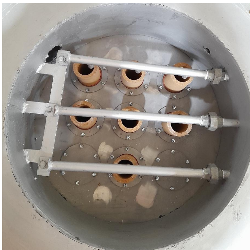
Figura 4. Sujeción de los elementos filtrantes cilíndricos.
